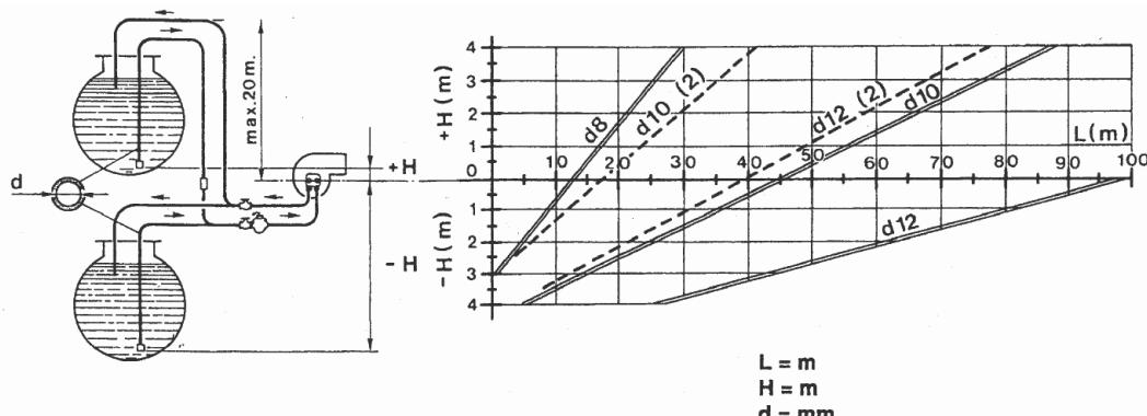
Прим.: Если длина трубопровода превышает 60 м, рекомендуется установка насоса подачи топлива - d10 (2), d12 (2): для горелок на два пламени.
