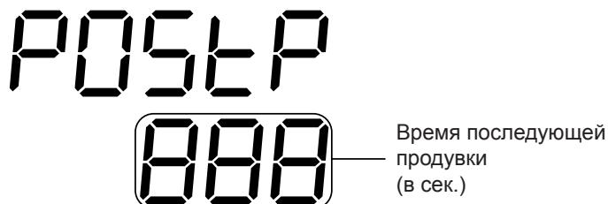
Нажатием кнопки *i* выполняется переход к режиму ИЗМЕНЕНИЕ ЗНАЧЕНИЯ ПАРАМЕТРА, при котором значение отображаемого параметра мигает.
